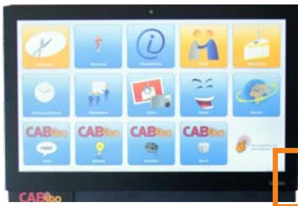
Zum Einschalten bitte mit einem Kugelschreiber (schlanke Mine) in dieses Loch an der Bildschirmseite kurz drücken.
