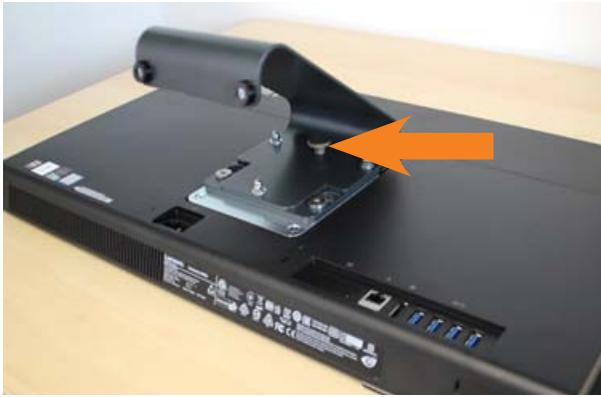
Schrauben Sie nun per Hand die Sicherungsschraube von hinten in die Vesa-Halterung. Die Schraube dabei nur handfest anziehen.
