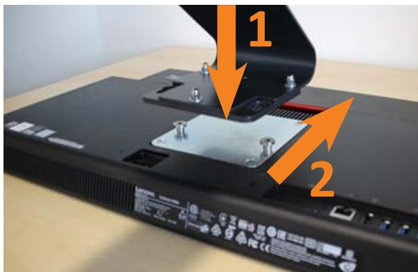
Entnehmen Sie der Geräteverpackung den Standfuß und hängen diesen in die Vesa-Halterung an der Bildschirmrückseite ein.
